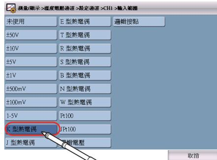
選取 K 型熱電偶時，設備將返回至 [CH1] 螢幕。
